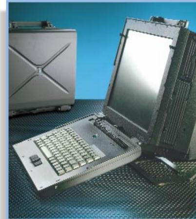
und eine Auflösung von 1024 x 768 Punkten. Außerdem gibt es einen Typ-III- beziehungsweise zwei Type-II-PCMCIA/CardBus-Steckplätze. Seine Energie kann der NotePAC außer aus seiner eingebauten Batterie und dem Strom-
