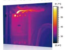
Die Infrarotinspektion spürt eine überhitzte Verbindung auf. Die Wärmebildtechnik lokalisiert dieses Problem, bevor es zu einem Ausfall kommt oder ein Feuer ausbricht.
