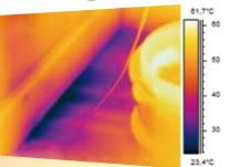
Das Infrarotbild zeigt eine Luftleckage. Die Lösung dieses Problems spart Energie und Geld.
