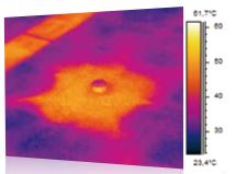
Das Infrarotbild zeigt deutlich Wasserschäden in der Dachhaut. Wasser ist durch eine Leckage eingedrungen, zerstört die Konstruktion und verursacht Schimmel.
