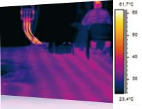
Das Infrarotbild zeigt eine Fußbodenheizung, die sich in einer Estrichschicht befindet. Die Inspektion belegt, dass die Heizung nicht korrekt installiert wurde. Ungleichmäßige Temperaturverteilungen sind die Folae.
