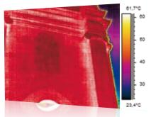
Die Infrarotinspektion zeigt eine zugemauerte Wandöffnung, die für das menschliche Auge nicht sichtbar ist. Dank der Wärmebildtechnik treten bei den Renovierungsarbeiten keine Verzögerungen oder ungeplanten Überraschungen auf.
