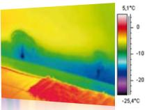
Das Inf<mark>rarotbild zeigt aufsteigende Feuch</mark>tigkeit bei einem Wasserschaden.
