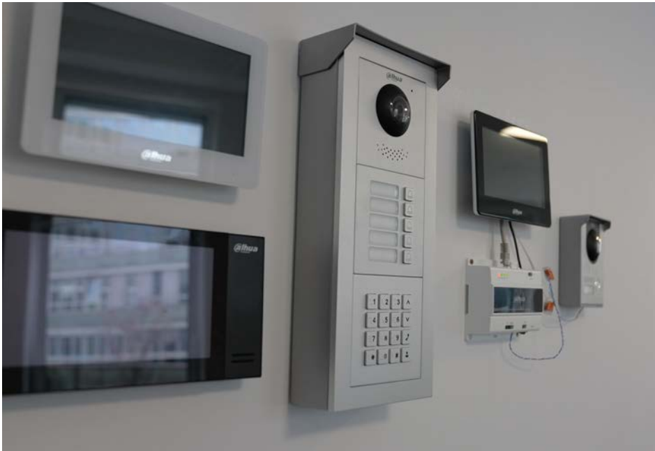
Im Demo-Van finden sich auch Zugangskontrollsysteme und Türsprecheinrichtungen.
